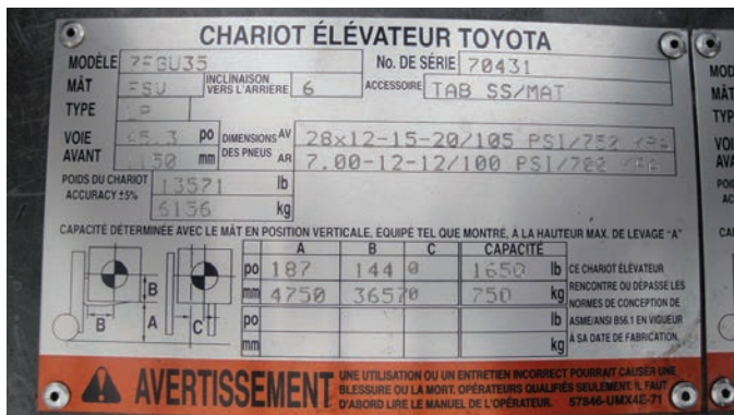
Capacité définie par le fabricant du chariot élévateur
