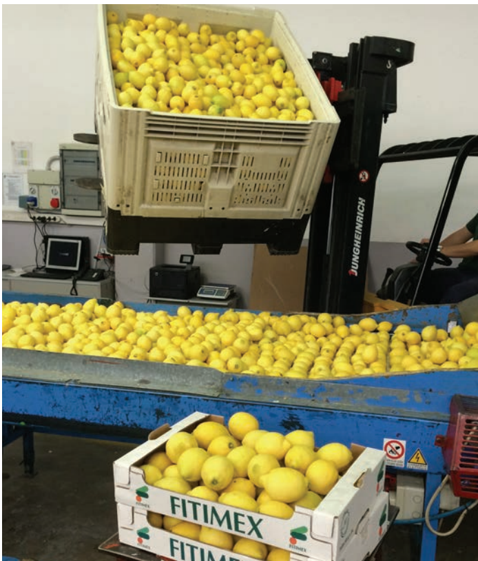
Chariot utilisant une tête rotative permettant un contrôle sur la charge
