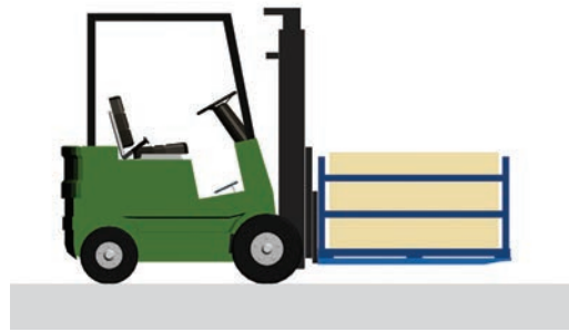
Déplacement d'une charge surdimensionnée avec rallonges de fourche
