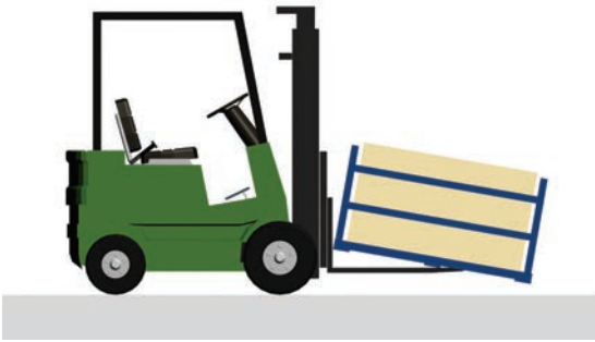
Déplacement d'une charge surdimensionnée sans rallonge de fourche
