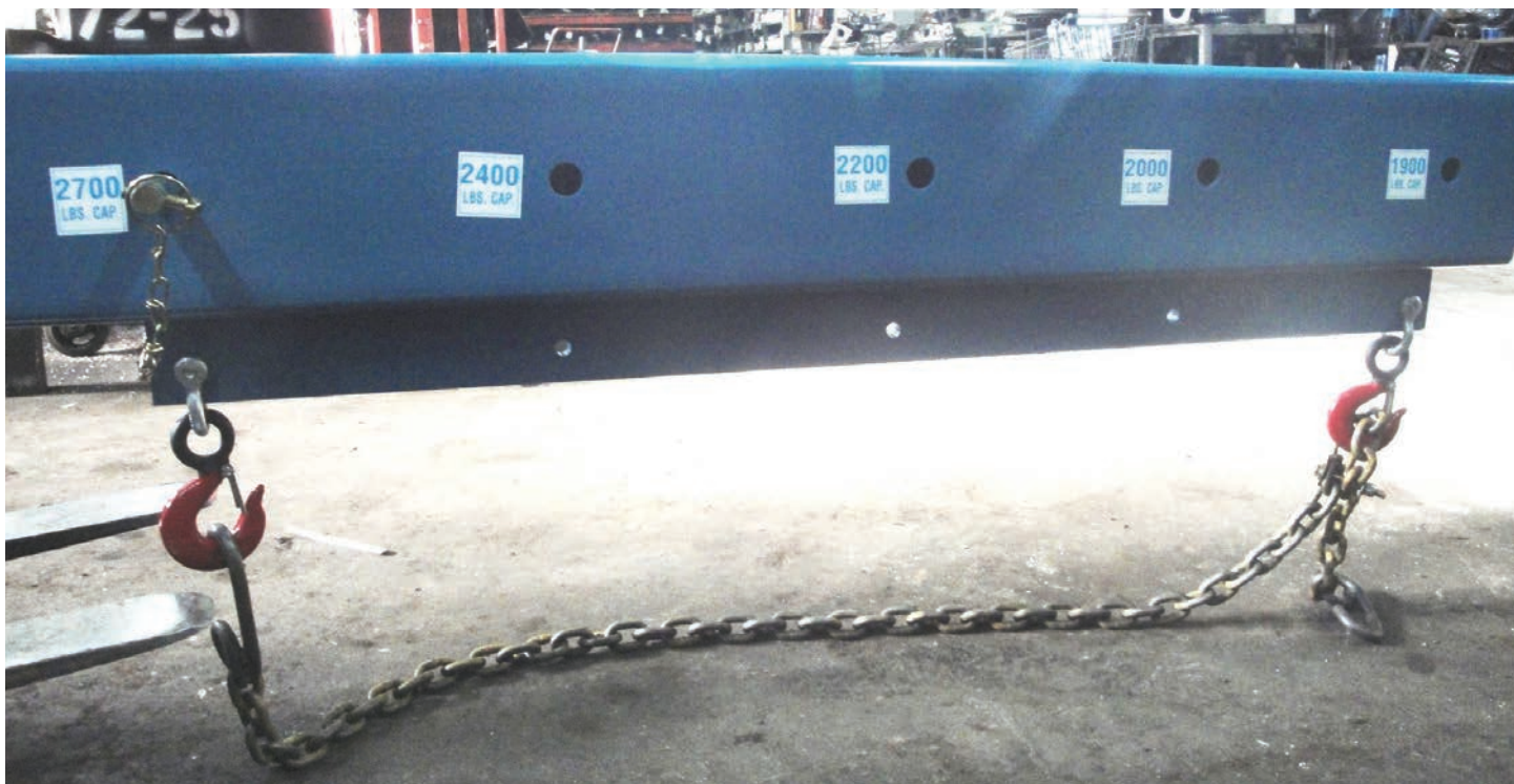
Exemple de capacité de charge d'une potence selon différents points d'ancrage
