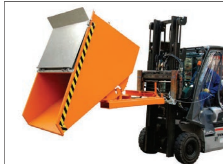
Chariot utilisant un accessoire ne permettant pas de contrôle sur la charge
