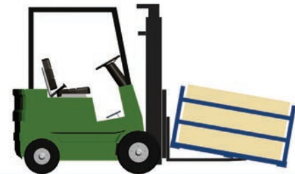
Danger de perte de chargement lors de la manutention de charges surdimensionnées)
