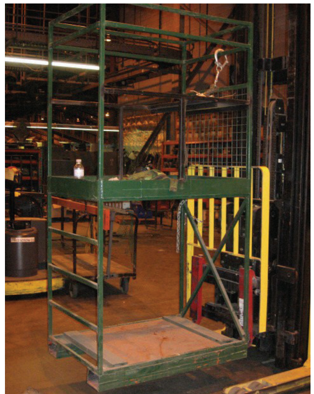
Plateforme de travail non conforme
