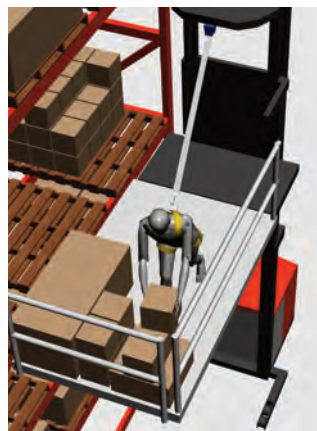
Chariot élévateur à poste de conduite élevable ayant une plateforme supplémentaire pourvu de garde-corps sur les côtés ouverts lorsqu'utilisé dans des allées larges
