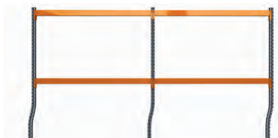
Flambage causé par une surcharge
