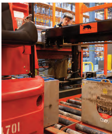
Extraction latérale par électromagnétisme
