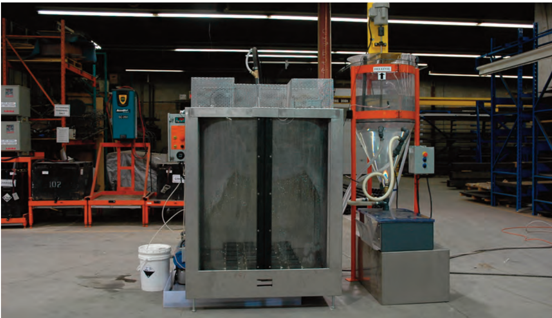
Station de lavage des batteries
