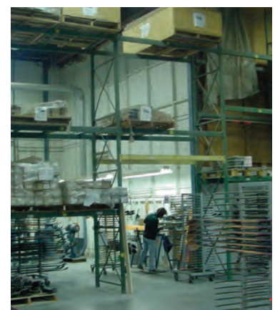
Poste de travail trop proche du palettier
