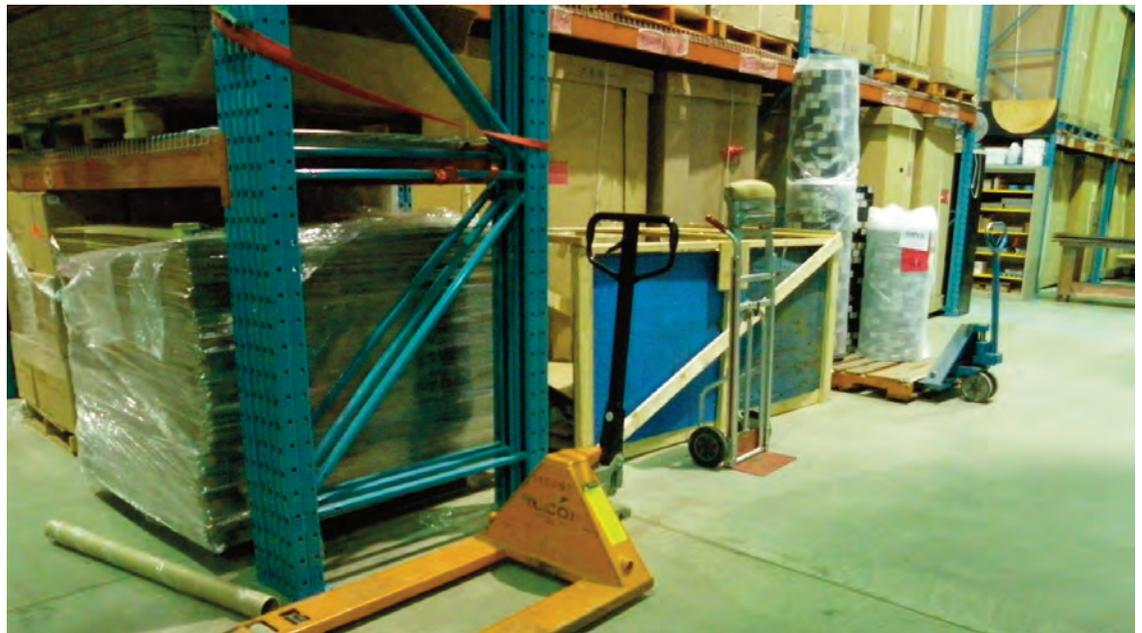
Une attention particulière doit être portée à l'absence de certains composants (par exemple, des traverses ou des diagonales qui manquent dans une échelle) et à la compatibilité des composants entre eux (par exemple, un mauvais alignement des trous des goupilles de sécurité).
